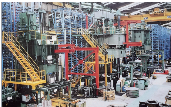
プレス機と金型倉庫。同社は国内最大級の鏡板専用プレス機を11台所有
